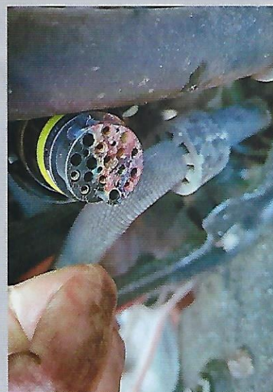
Een bekend probleem. De koelvloeistof lekt op de inmiddels geoxideerde stekker van een Audi Stronic (DSG). Foto Maarten Gofflo.
