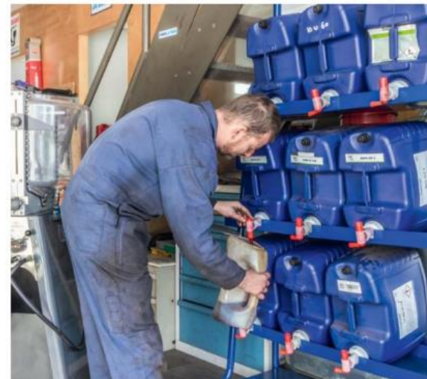
Edwin van der Gracht gebruikt voor een spoelbeurt meestal tussen de twaalf en twintig liter ATF.
