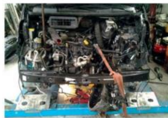
Dit is geen gevalletje spoelen, want van deze semi-automaat van een Opel Vivaro verving Arno Bruin (Garage Ger Bruin, Winkler) de koppeling. Het zijn de meest voorkomende reparaties in zijn bedrijf.
