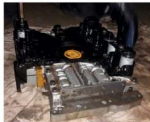
Spoelen hielp niet meer, dus Ferry Kuhlman van Auto Verhaag verving het brein. Reparaties en revisies aan hand- en automaatbakken doen ze bij Verhaag meestal in eigen huis.
