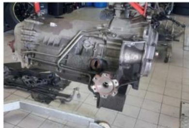
Dit is de boosdoener: de automaat van een Porsche 997 turbo, overigens gemaakt door Mercedes. De automaat viel onder verlengde garantie en is vervangen door een ruilbak. Jammer, want Ludo Nachtgeal had 'm graag open gemaakt.
